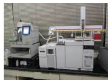
ガスクロマトグラフ質量分析計 （カビ臭物質の測定）
