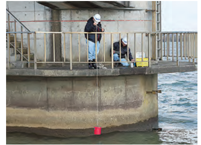
水源(河川水)の採水と現地での検査の様子
