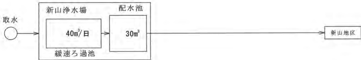
新山浄水場配水系統図 (施設能力 40m 3 /日)
