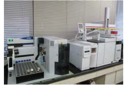
ガスクロマトグラフ質量分析計 (カビ臭物質の測定)
