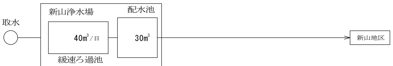
新山浄水場送配水系統図 (施設能力 40m 3 /日)
