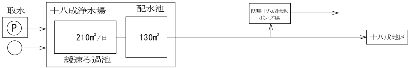
網地島浄水場送配水系統図 (施設能力 690m 3 /日)
